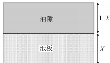
图2 变压器主绝缘 X 模型
